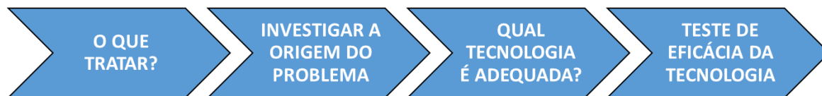
Figura 3 – Etapas de qualificação de uma tecnologia de purificação do ar em ambientes internos.
