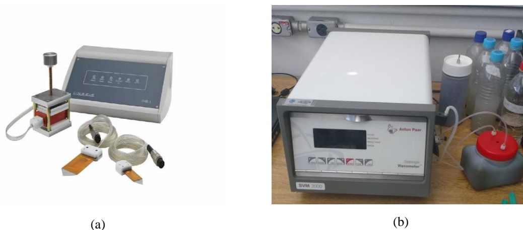
Figura 2. Equipamento de medição de propriedades termofísicas. (a) conductivímetro Linesis THB-1, (b) viscosímetro SVM-3000 da Anton Paar.
