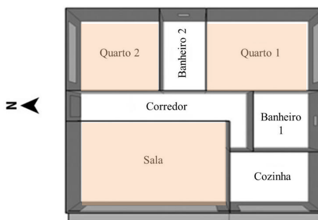
Figura 2. Esboço da planta baixa da casa padrão com destaque para as zonas térmicas climatizadas artificialmente.
