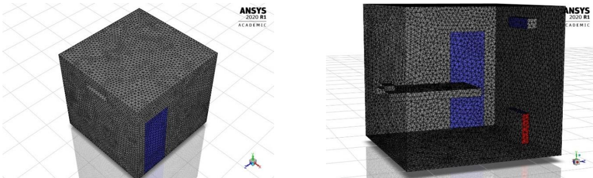
Figura 4. Malha Computacional do Leito de Isolamento da Unidade de Terapia Intensiva
