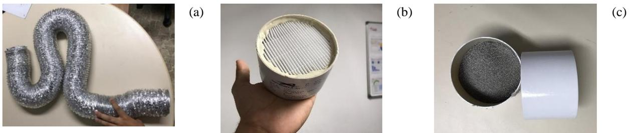
Figura 3. Duto Condutor (a); Filtro HEPA H-14 (b); Pré-Filtro (c)
