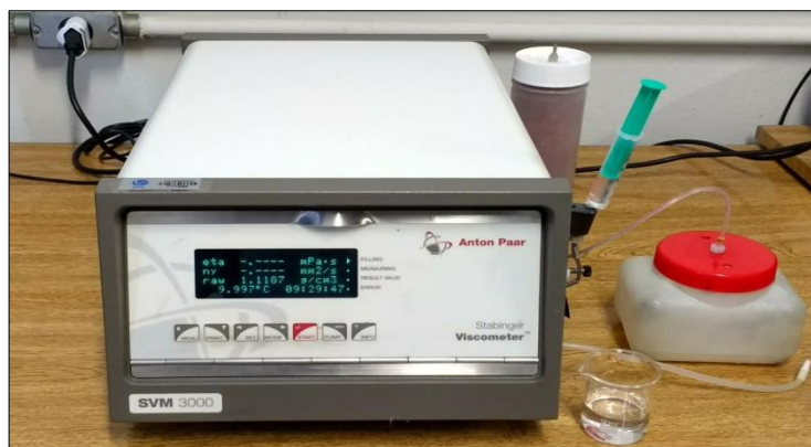
Figura 4. Viscosímetro utilizado para medição da viscosidade e massa específica do nanofluidos. Fonte: Oliveira (2018).
