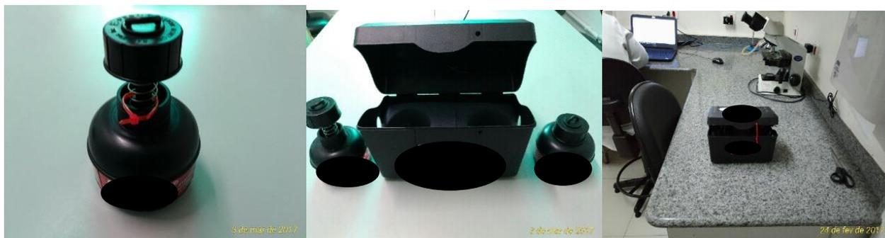
Figura 1. Célula de amostragem utilizada nos experimentos (esquerda), caixa de amostragem (centro) e sistema de amostragem em operação (direita)
