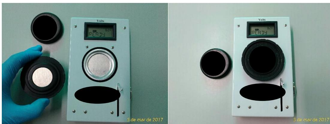
Figura 2. Sistema de detecção composto por uma câmara de íons (seguro pela mão na foto à esquerda) e voltímetro utilizado nas medições de radônio
