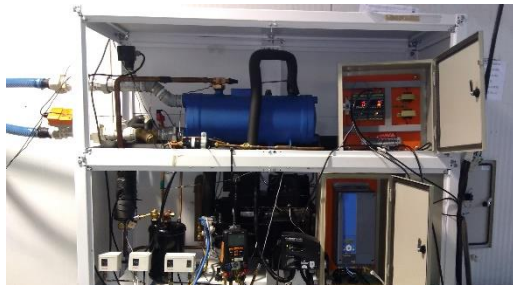
Figura 7. Monobloco frigorífico em fase de teste
