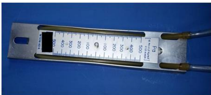
Figura 3. Manômetro em U utilizado para medir a diferença de pressão no filtro absoluto (Fonte própria).
