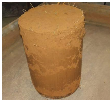
Figura 5. Corpo de Prova compactado (Fonte: Autor, 2022)
