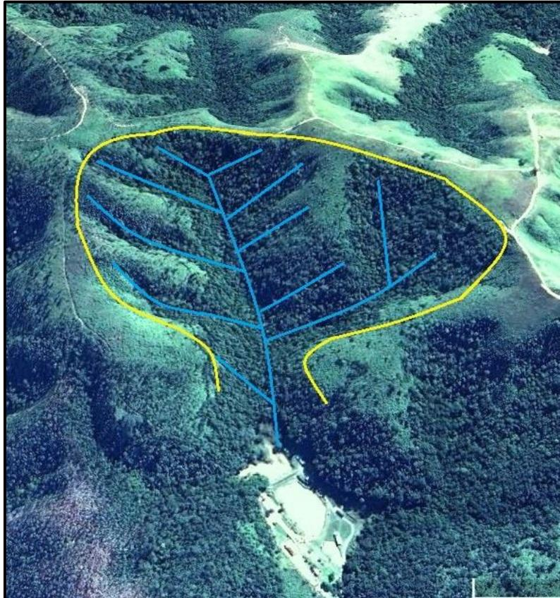
**Figura 8:** Cabeceira de drenagem tipo e esquema do dreno espinha de peixe
