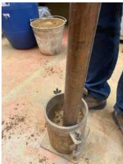
Figura 3. Processo de compactação dos materiais investigados.
