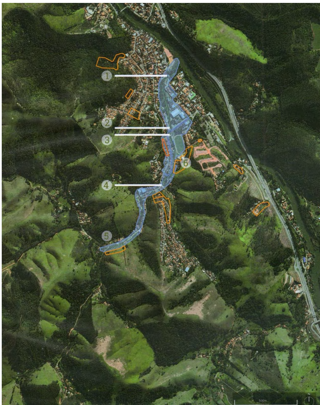
Figura 4. Levantamento da REGEA sobre as áreas sujeitas a inundações e escorregamentos. Em laranja, as áreas com risco alto de escorregamento (R3). Em vermelho, as áreas com risco muito alto de escorregamento (R4). Em azul, as áreas com risco de inundação.
