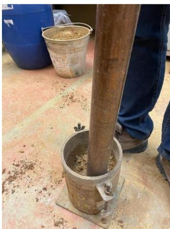
Figura 4. Processo de compactação com soquete grande e cilindro CBR.
