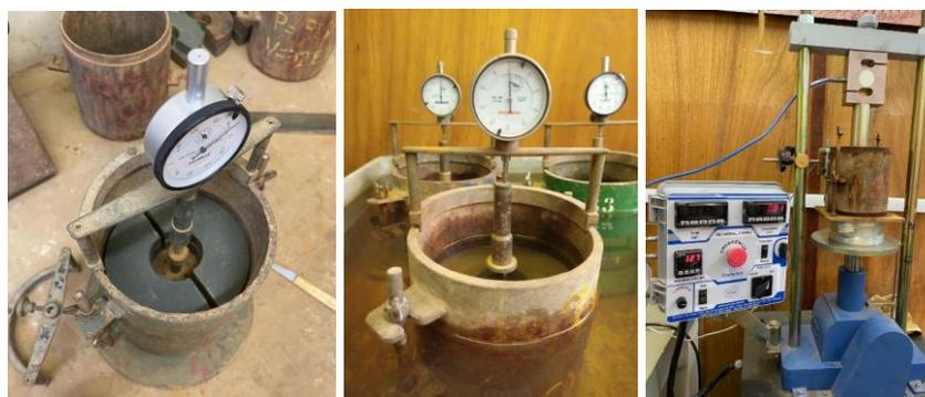
Figura 5. Montagem do ensaio de ISC.
