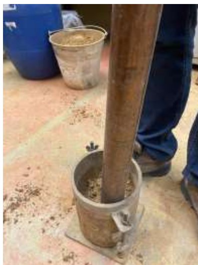
Figura 5. Processo de compactação dos materiais investigados.
