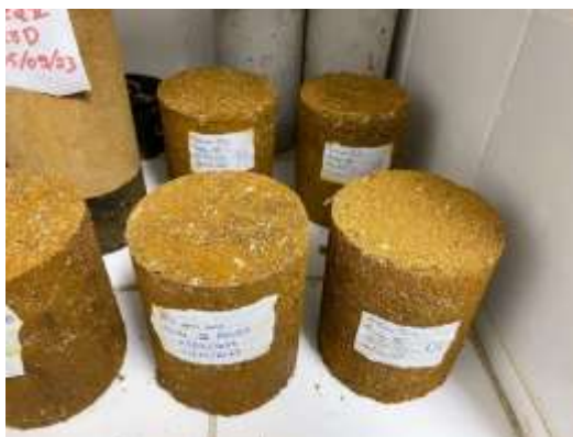
Figura 6. Corpos de prova da mistura solo-RCC dispostos na câmara úmida.
