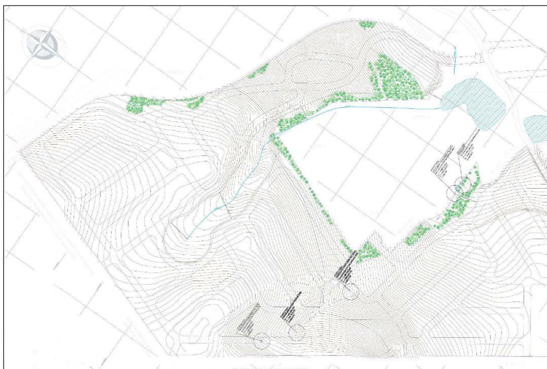
Figura 3. Pontos de sondagem e instalação de piezômetros para monitoramento dos níveis d'água, conforme mapa topográfico apresentado pelo interessado do loteamento residencial. (Fonte: RAP, 13/11/2017).
