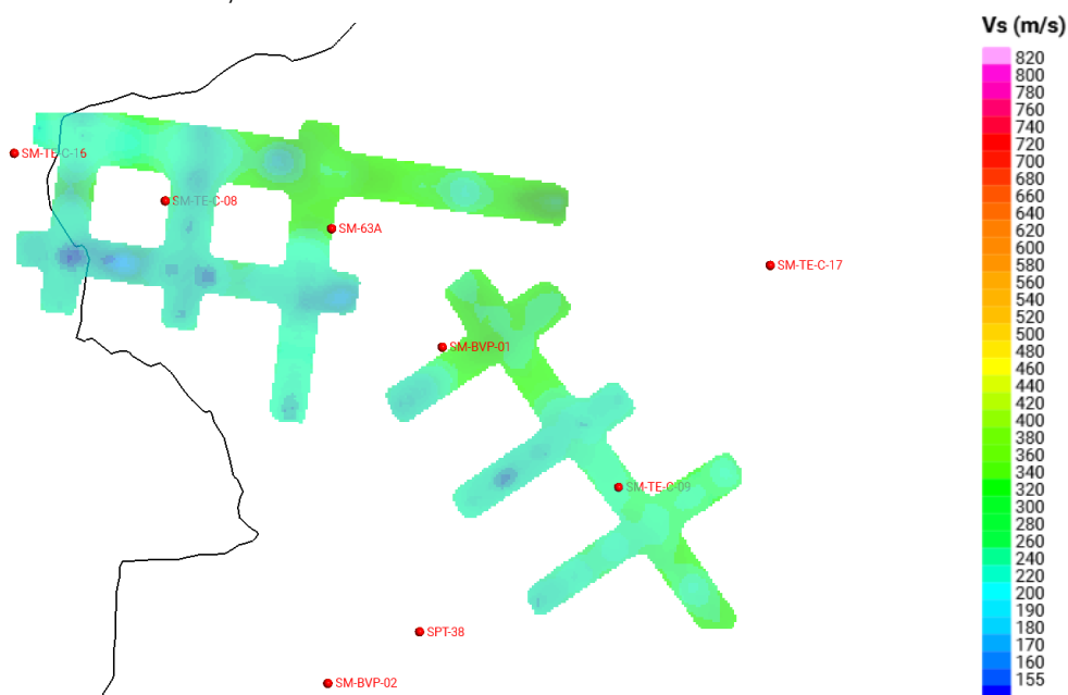
Figura 9 – Vista em planta do voxel. A vista é observada no software Leapfrog Works, com as sondagens utilizadas na modelagem tridimensional. (Fonte: RL_ENG_VALE_MINA DE BRUCUTU_PDER TAMANDUÁ_PILHAS INICIAIS_MASW=0).
