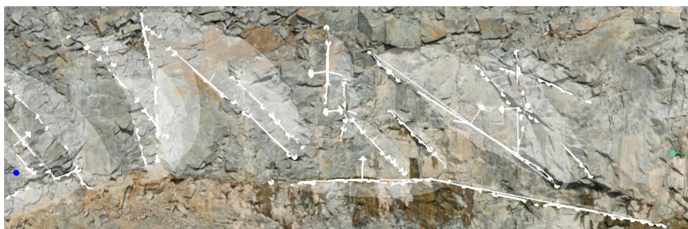
Figura 2. Representação das descontinuidades mapeadas com “ Trace ”, no Sirovision (Datamine®) .
