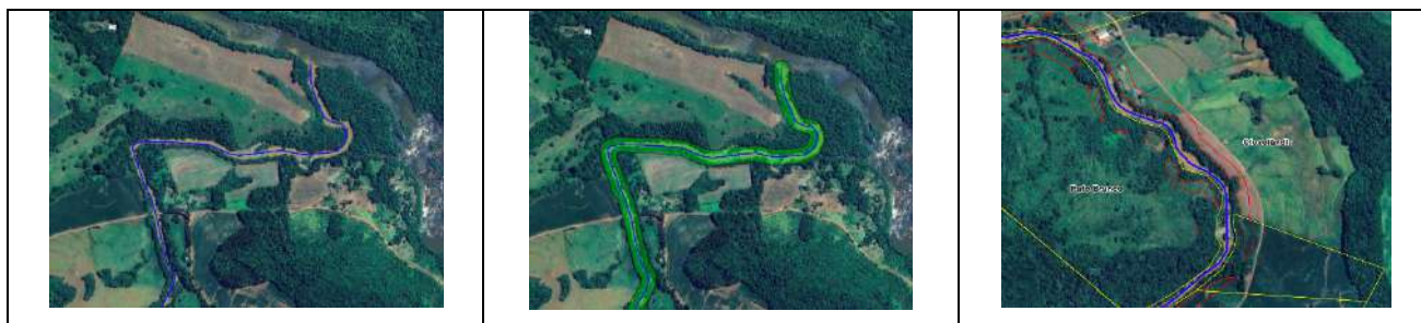
Figura 02 – Buffer realizado a partir das margens do rio, destacando as Áreas de Preservação Permanente (APPs) com 30 metros de largura e evidenciando as áreas com vegetação suprimida.
