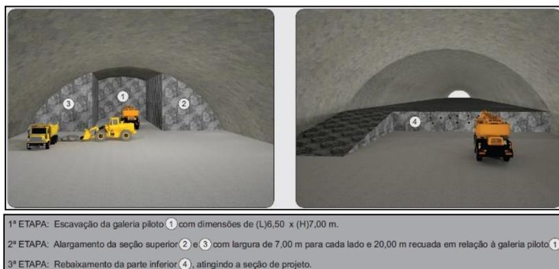
Figura 17 – Sequência de etapas de execução do túnel. Fonte: CONSÓRCIO ARG-CIVILPORT (2010)
