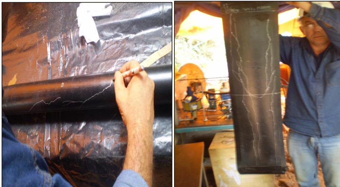
**Figura 2** – À esquerda, realce do traço da fratura com caneta. À direita, borracha de impressão das fraturas geradas nos ensaios de faturamento hidráulico mostrando dois conjuntos de traços de fraturas verticais dispostos a  $180^\circ$  um do outro. Notar o traço na forma de um arco, de uma fratura inclinada, pré-existente, à meia altura da borracha.
