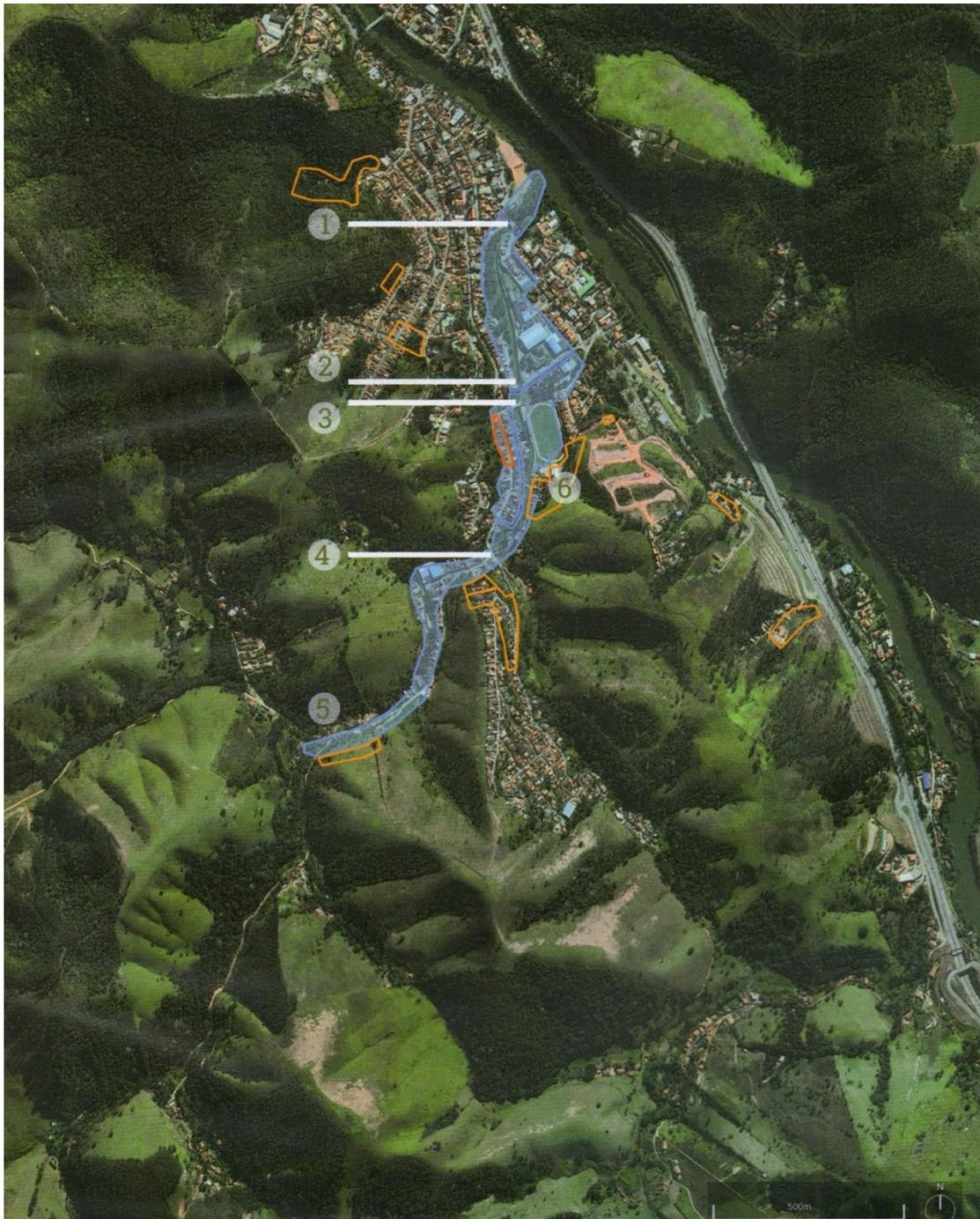
Figura 4. Levantamento da REGEA sobre as áreas sujeitas a inundações e escorregamentos. Em laranja, as áreas com risco alto de escorregamento (R3). Em vermelho, as áreas com risco muito alto de escorregamento (R4). Em azul, as áreas com risco de inundação.
