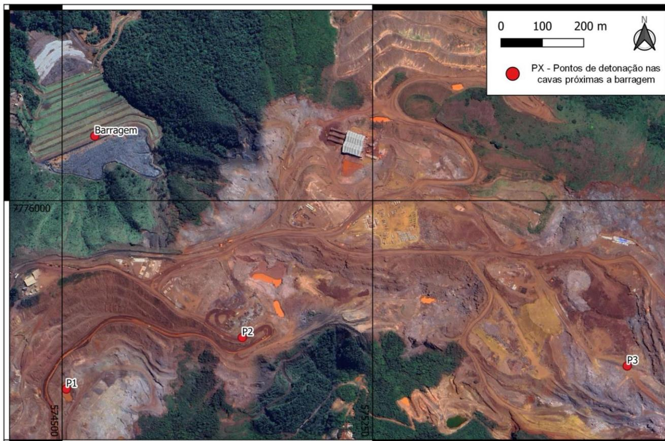
Figura 1. – Mapa de localização das cavas com os pontos de detonações mais próximos da Barragem B2 Tico-Tico.
