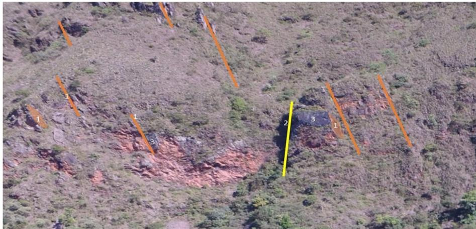
Figura 8. Ampliação da imagem da face da serra para detalhamento do maciço rochoso e das fraturas correspondentes às famílias 1, 2, 3 que delimitam e condicionam as rupturas dos blocos rochosos.
