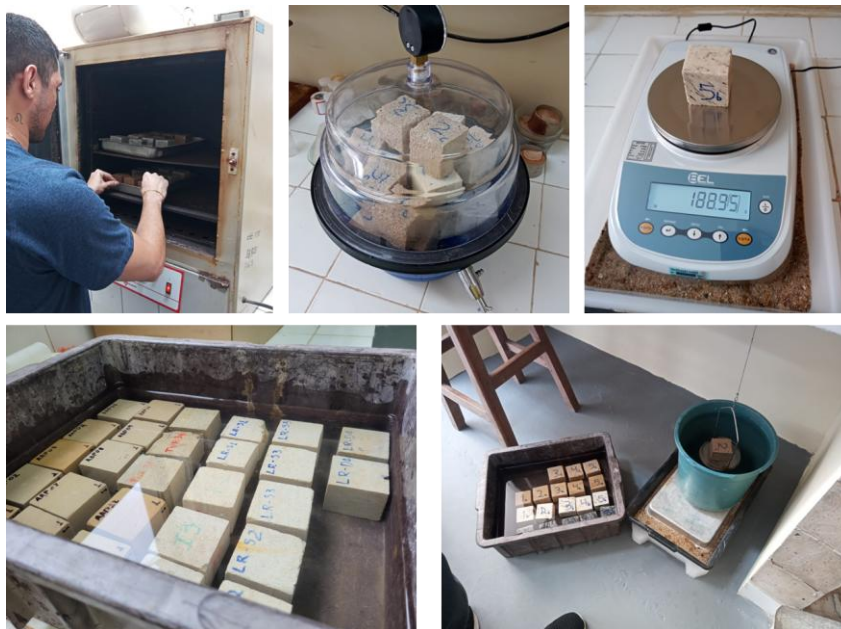
Figura 8. Ensaios de densidade aparente, porosidade aparente e absorção de água (índices físicos) em amostras de beachrocks e construções carbonáticas biogênicas (recifes).
