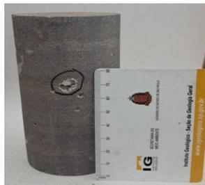
CP 08, Vesículas com diâmetro entre 1 e 35 mm foram identificadas, associadas a amígdalas de dimensões entre 1 e 20 mm. Essas estruturas apresentam preenchimento poliminerálico, composto por celadonita, calcedônia, zeólita e quartzo, conforme caracterização mineralógica detalhada.
