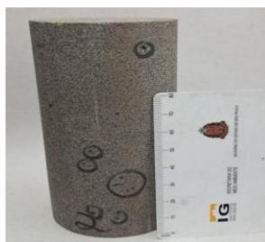
CP 02, Vesículas com diâmetro entre 1 e 5 mm foram observadas, associadas a amígdalas de dimensões variando de 1 a 3 mm. Tais estruturas apresentam-se integralmente preenchidas por celadonita, conforme identificado em análise mineralógica.
