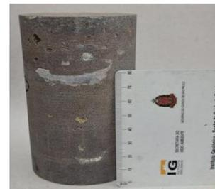
CP 09, Vesículas com diâmetro entre 1 e 30 mm foram observadas, associadas a amígdalas de dimensões entre 1 e 30 mm. Essas estruturas exibem preenchimento poliminerálico, constituído por celadonita, calcedônia, zeólita e quartzo, conforme caracterização mineralógica detalhada.
