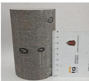
CP 01, Vesículas com diâmetro entre 1 e 2 mm foram observadas, associadas a amígdalas de dimensões variando de 1 a 3 mm. Tais estruturas apresentam-se integralmente preenchidas por celadonita, conforme identificado em análise mineralógica.
