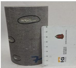
CP 07, Vesículas com diâmetro entre 1 e 20 mm foram identificadas, associadas a amígdalas de dimensões entre 1 e 20 mm. Essas estruturas apresentam preenchimento poliminerálico, composto por celadonita, calcedônia, zeólita e quartzo, conforme caracterização mineralógica realizada.
