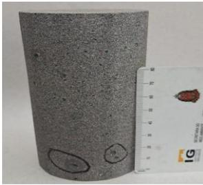
CP 04, Vesículas com diâmetro entre 1 e 5 mm foram identificadas, associadas a amígdalas de dimensões entre 1 e 4 mm. Essas estruturas exibem preenchimento combinado por celadonita e calcedônia, conforme caracterização mineralógica realizada.
