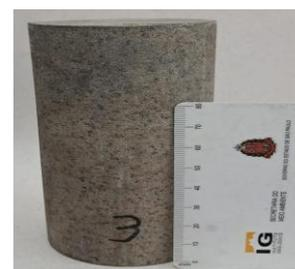
CP 03, Não foram identificadas vesículas nas amostras analisadas. Entretanto, constatou-se a ocorrência de amígdalas com dimensões reduzidas em comparação aos demais corpos de prova (CP), apresentando diâmetro entre 0,2 e 0,5 mm. Essas estruturas exibem preenchimento completo por limonita.
