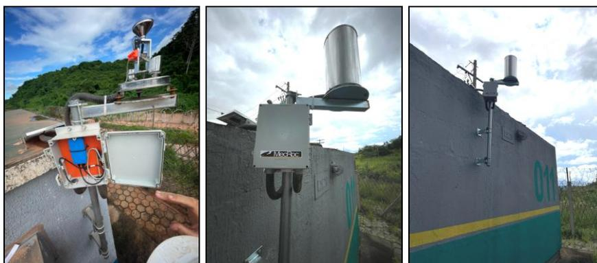
Figura 3. Instalação do sistema de monitoramento via satélite de pluviometria.
