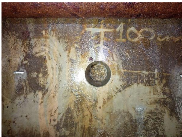
Figura 8. Extração de corpos de prova das aduelas para execução de ensaios de resistência à compressão axial (fonte: ALTA Geotecnia, 2022).
