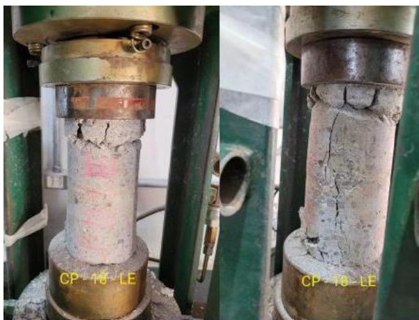
Figura 9. Corpos de prova do concreto das aduelas em ensaios de resistência à compressão axial (fonte: ALTA Geotecnia, 2022).
