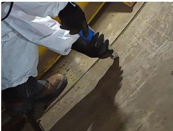
Figura 10. Ensaio de esclerometria (fonte: ALTA Geotecnia, 2022).
