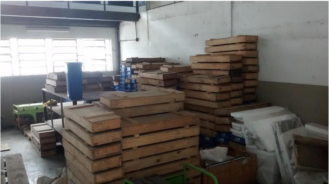
Figura 4. Acondicionamento das amostras das sondagens rotativas da obra.
