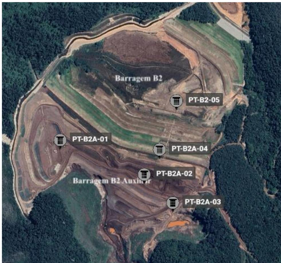
Figura 3 – Localização dos poços tubulares de rebaixamento.
