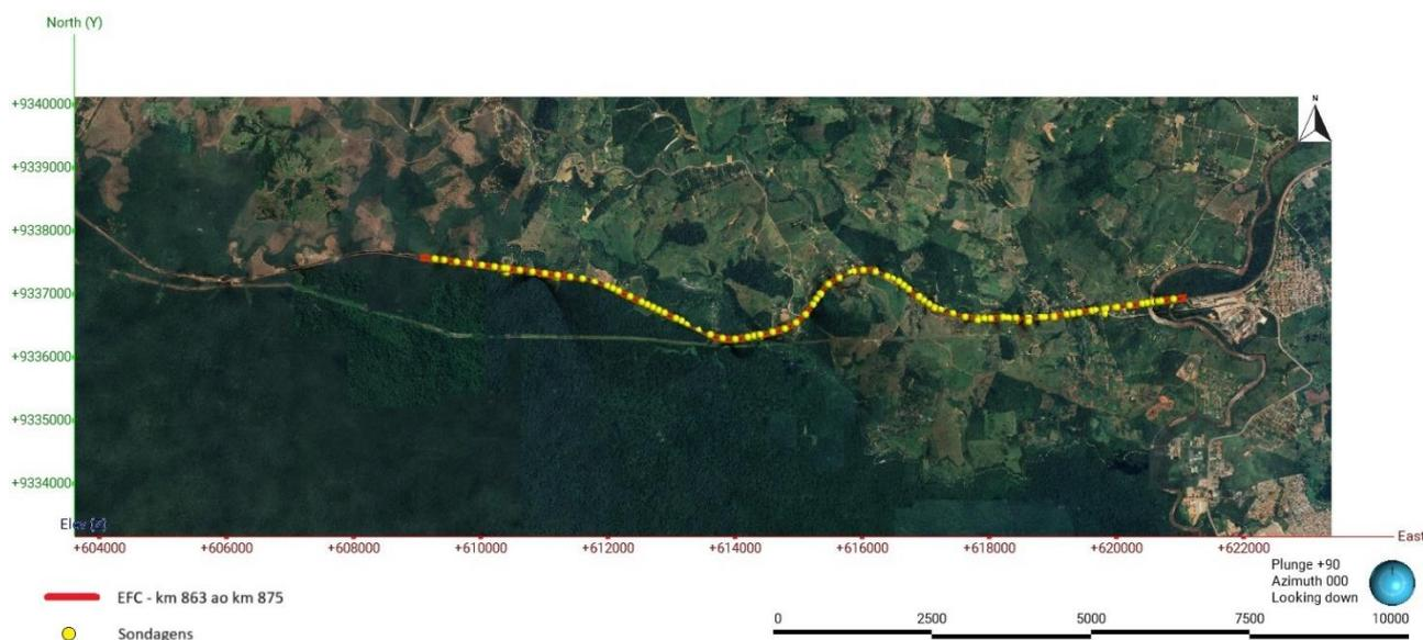
Figura 3: Distribuição em planta das sondagens na extensão da linha férrea da EFC, entre os km 863 e 879.
