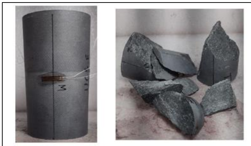
Figura 9. Exemplo de ruptura do tipo Catáclase.
