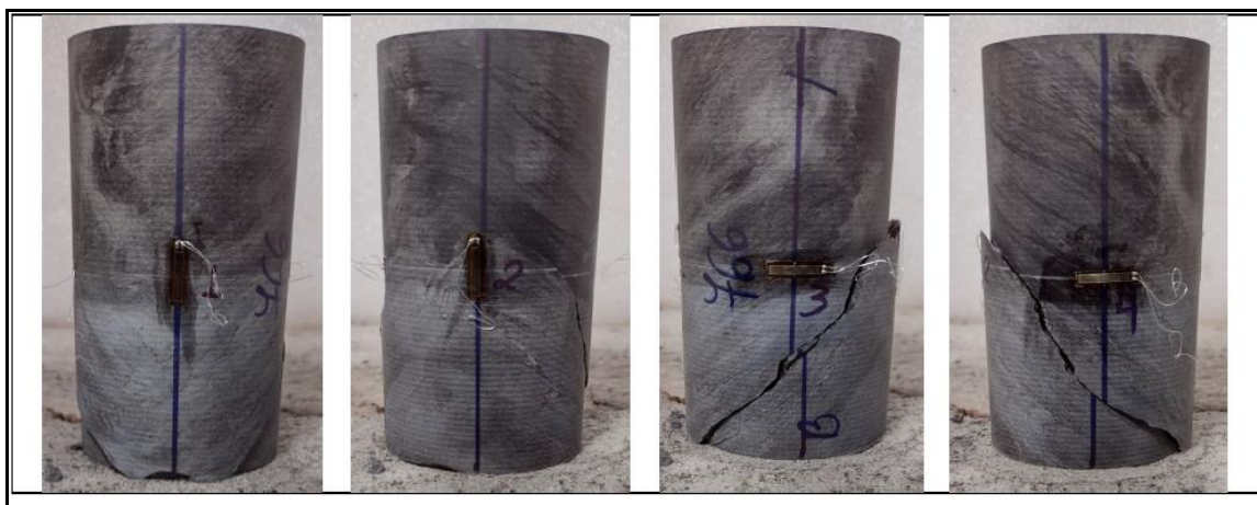
Figura 5. Exemplo de ruptura mista: Cisalhamento – Estrutural/Rocha Intacta.
