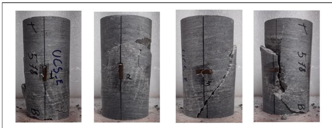
Figura 4. Exemplo de ruptura por Cisalhamento – Rocha Intacta.
