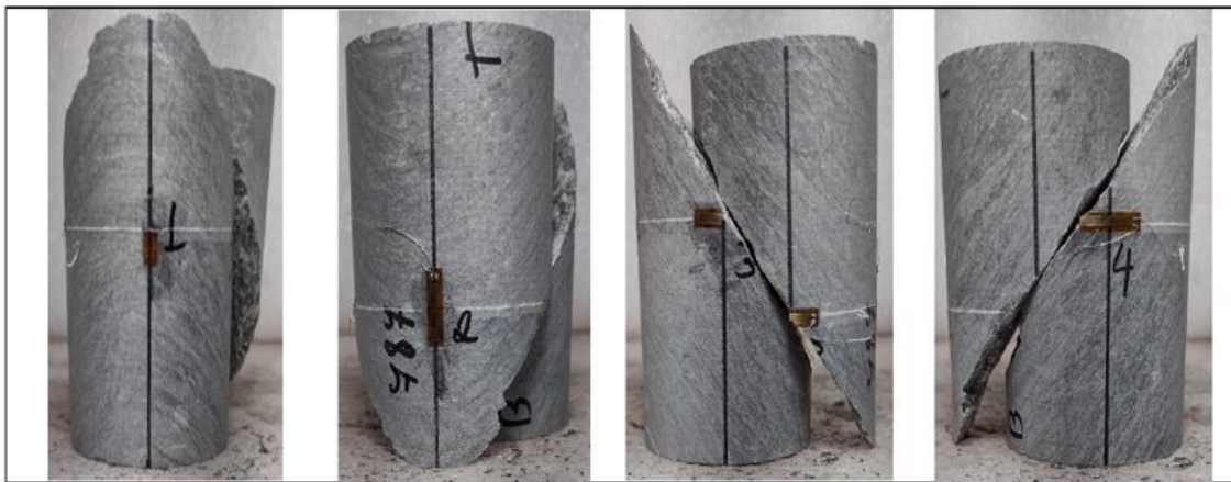
Figura 3. Exemplo de ruptura por Cisalhamento Estrutural, paralela ao plano de anisotropia.
