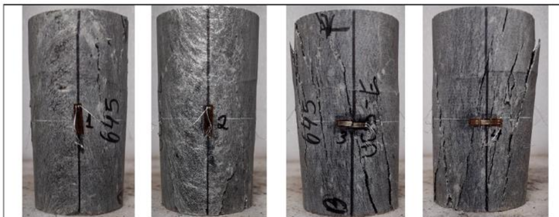
Figura 6. Exemplo de ruptura por Clivagem Axial.
