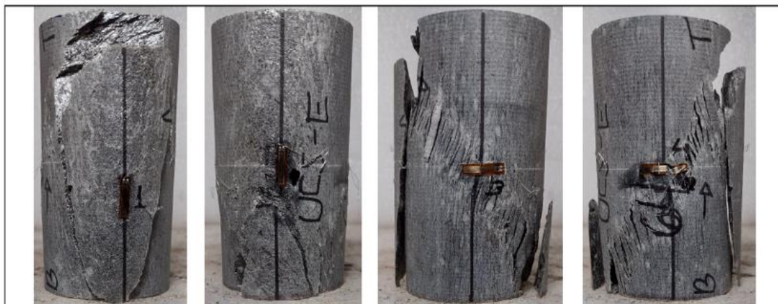
Figura 7. Exemplo de ruptura do tipo Kink Band .
