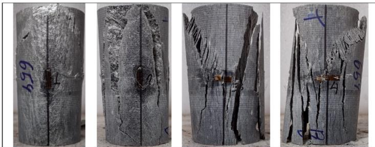
Figura 8. Exemplo de associação entre os tipos de ruptura Clivagem Axial e Kink Band .
