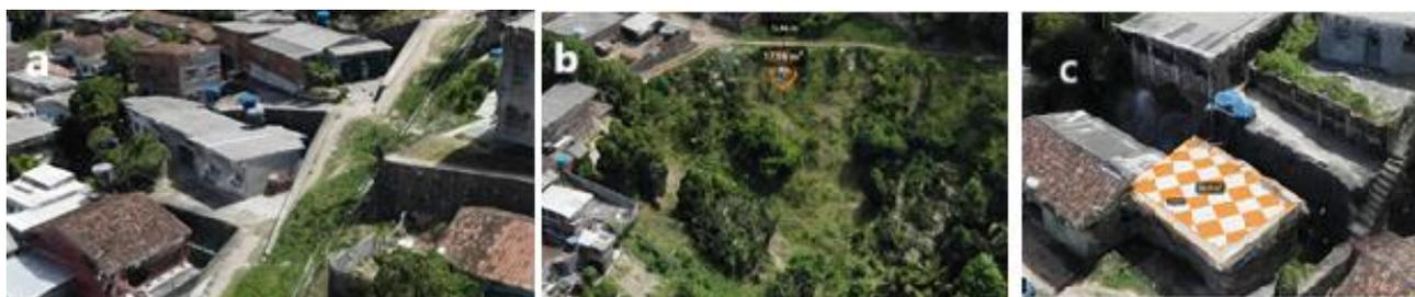
Figuras 06: Modelos 3D: a) Contenção de encostas; b) Descarte de resíduos sólidos no topo da encosta; c) Geometria das edificações e escadarias
