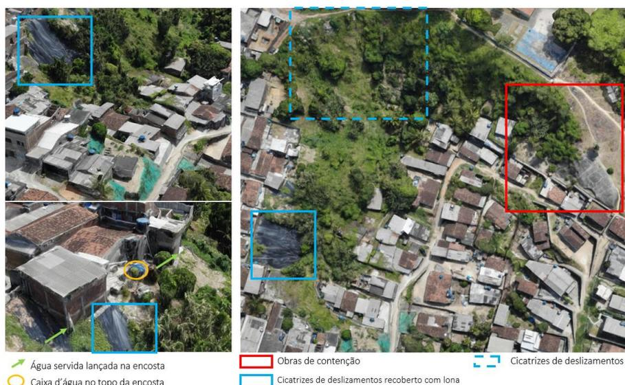
Figura 07 - Detalhamento dos dados cicatrizes de deslizamentos a partir do modelo 3D.
