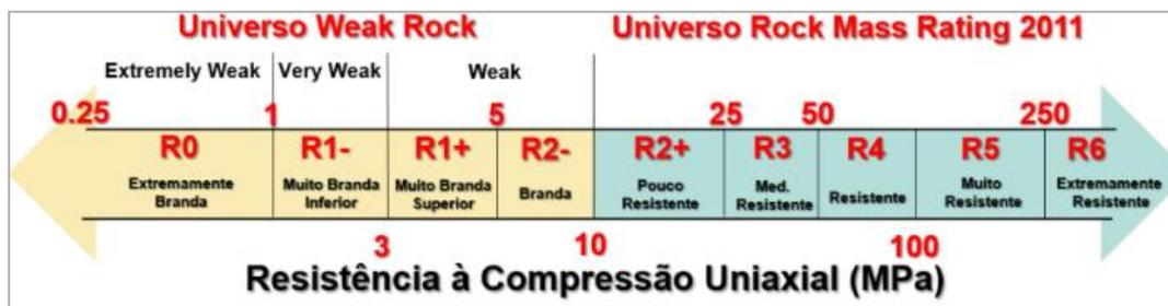
Figura 2: Correlação entre a classificação Weak Rocks e do Rock Mass Rating em função da resistência à compressão uniaxial dos materiais. Fonte: PROC\_Classificação\_Geomecânica (2019).
