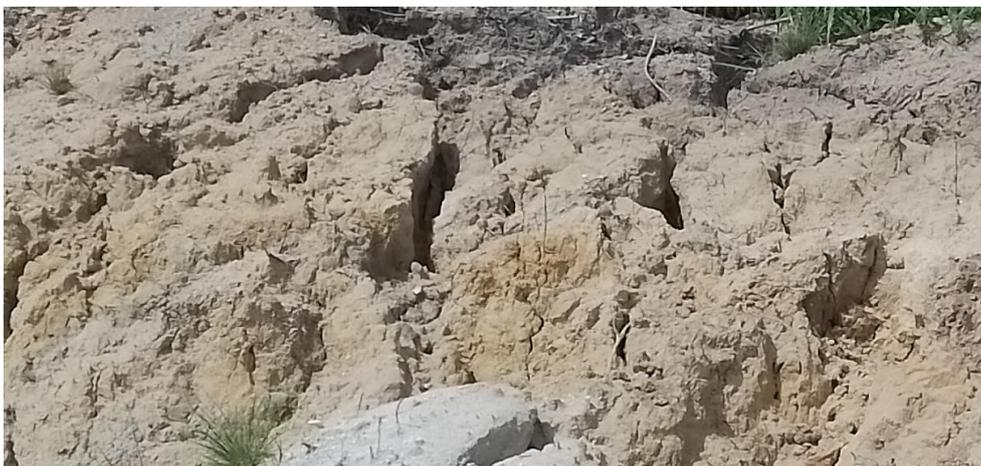
Figura 6. Aspecto da textura da camada de arenito. Notar a presença de ravinas erosivas em virtude de suas características texturais
