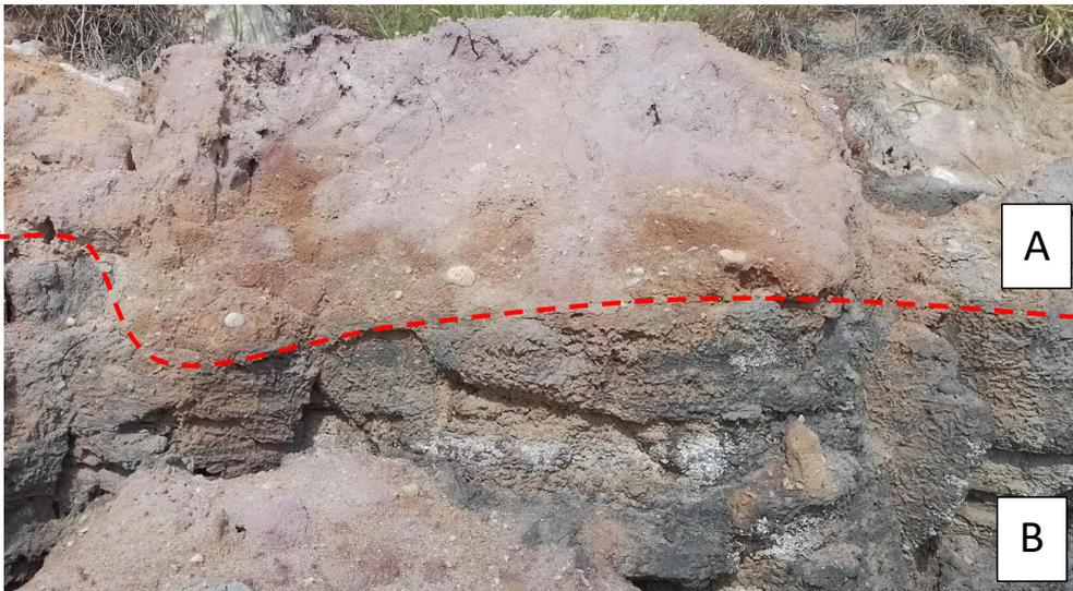
Figura 5. Contato entre a camada intermediária de textura silte-argilosa (A) com a inferior de folhelhos (B)
