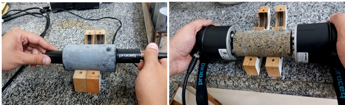
a) b) Figura 2. Medição das velocidades das ondas. a) Ondas P; b) Ondas S.
