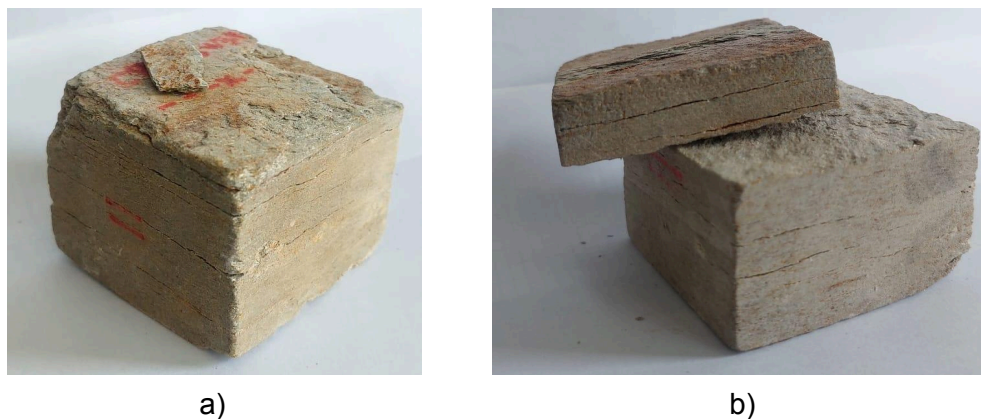
Figura 5. Amostra de filito. a) Planos de foliações; b) Amostra desintegrada após saturação
