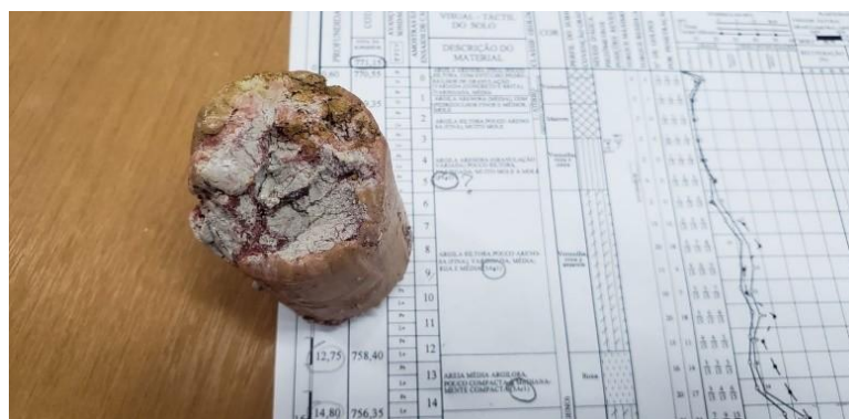
Figura 2. Detalhe de fragmento de um testemunho de sondagem e seu respectivo boletim de sondagem
