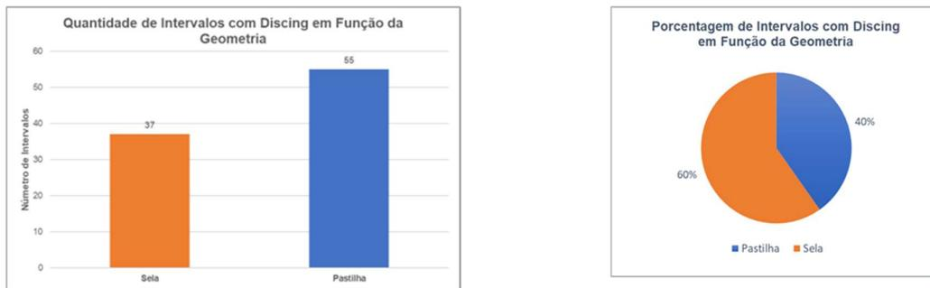
Figura 6. Gráficos que apresentam o número e porcentagem dos intervalos geomecânicos em que ocorre o *discing*, separados pelo formato dos discos.
