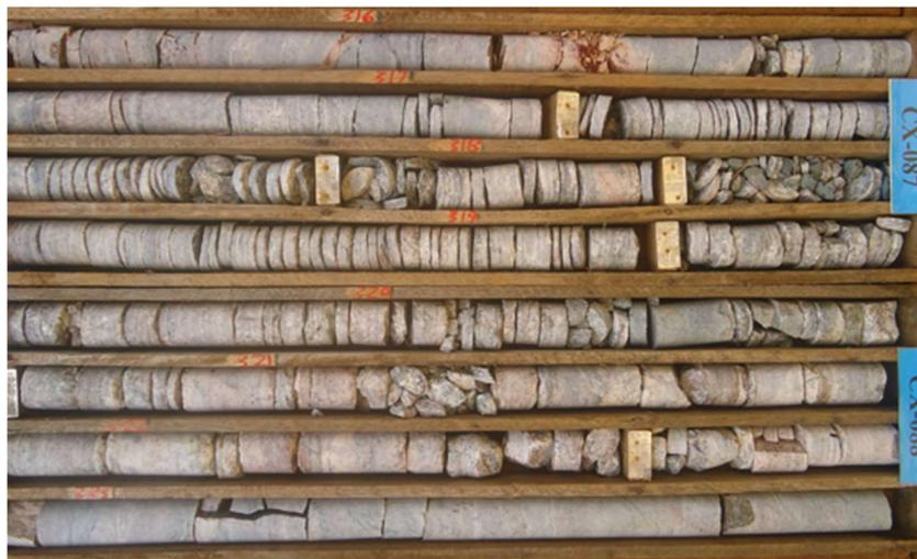
Figura 7: Exemplo da ocorrência de *discing* nos testemunhos de sondagens.
