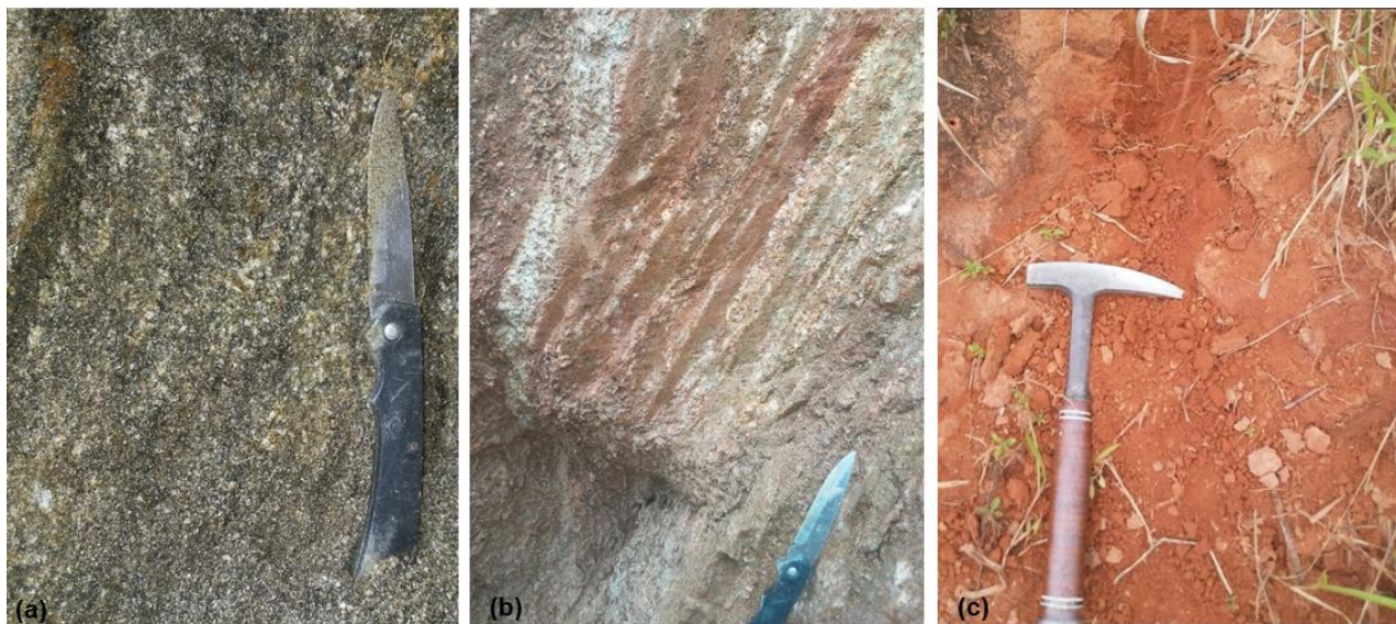
Figura 3. Ilustrações de detalhe dos horizontes de solo: (a) solo de alteração (bancada 5); (b) solo de transição (bancada 7); e (c) solo eluvial (bancada 8).
