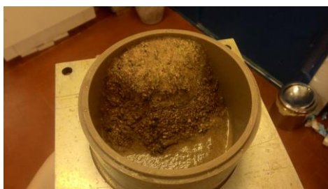
A) Ensaio realizado para uma vazão de 6 l/min B) Ensaio realizado para vazão de 3 l/min
