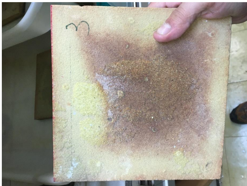
Figura 3. Face da placa 3 após o ensaio, com áreas descoloridas amareladas e partes com cristais brancos precipitados, ao meio.
