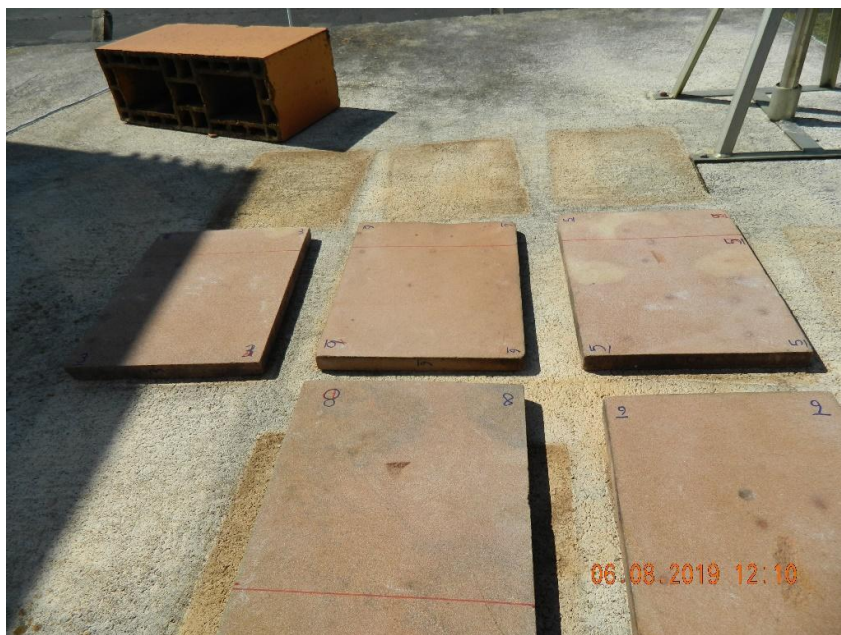
Figura 2. Placas do conjunto 2 antes do ensaio de alteração acelerada.
