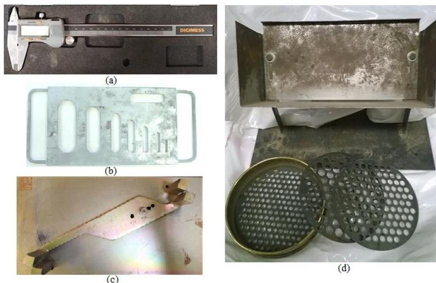
Figura 1. (a) Paquímetro Digital; (b) Placa de Lamelaridade; (c) Paquímetro Calíper; (d) Crivos Redutores.
