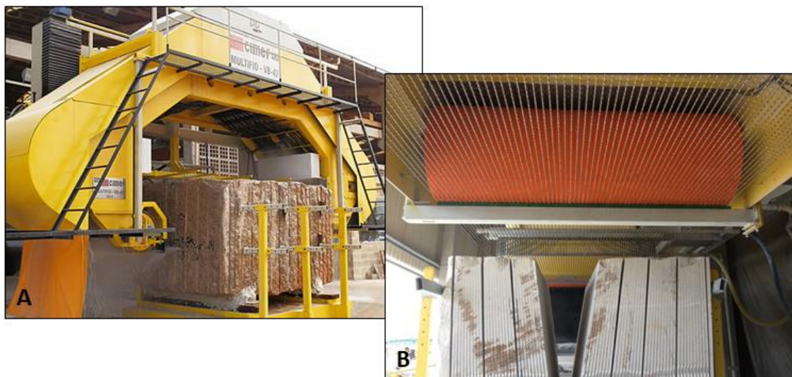
Figura 1. (A) Tear multifios diamantados em operação;(B) Detalhe mostrando, na parte superior, os fios diamantados e, abaixo, as chapas obtidas pelo corte de bloco de granito. Fontes: http://www.cimef.com.br/pt/prod_teares_multifio_vb_42.php#prettyPhoto; http://inventory.granibras.com.br/AboutUs.aspx.
