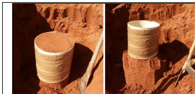
Figura 8 – Imagens da coleta de amostras indeformadas.
