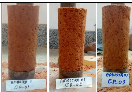
Figura 9 – Moldagem dos corpos de prova para realização de ensaios triaxiais.
