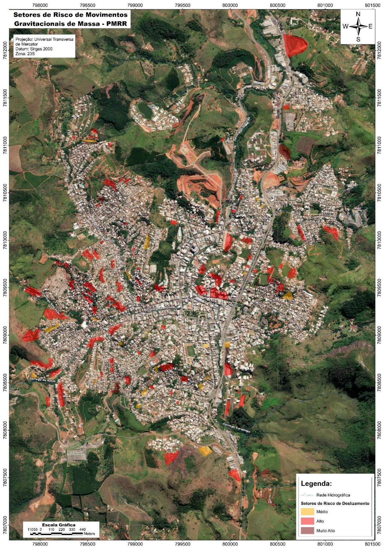
Figura 4 – Resultado da setorização do risco geológico na sede do município de Caratinga – MG, no âmbito do Plano Municipal de Redução de Risco.
