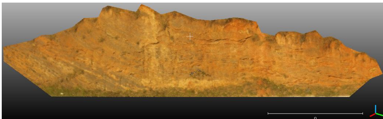
Figura 3 – Nuvem de pontos 3D coloridos e recortada para o talude estudado (km 5 da ES-482). Unidade em metros.
