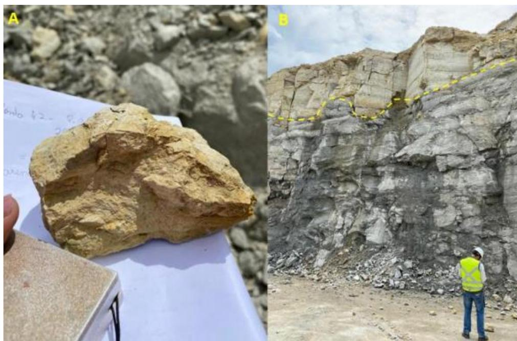
Figura 3. Em (A), amostra de mão da marga. Em (B), contato gradacional entre a marga sobre calcário superior, ambos pertencentes à Formação Gramame.
