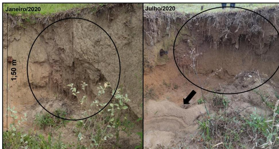
Figura 11. Feição erosiva associada a Latossolo Vermelho. a) Estágio evolutivo em Janeiro de 2020. b) Estágio evolutivo em Julho de 2020.
