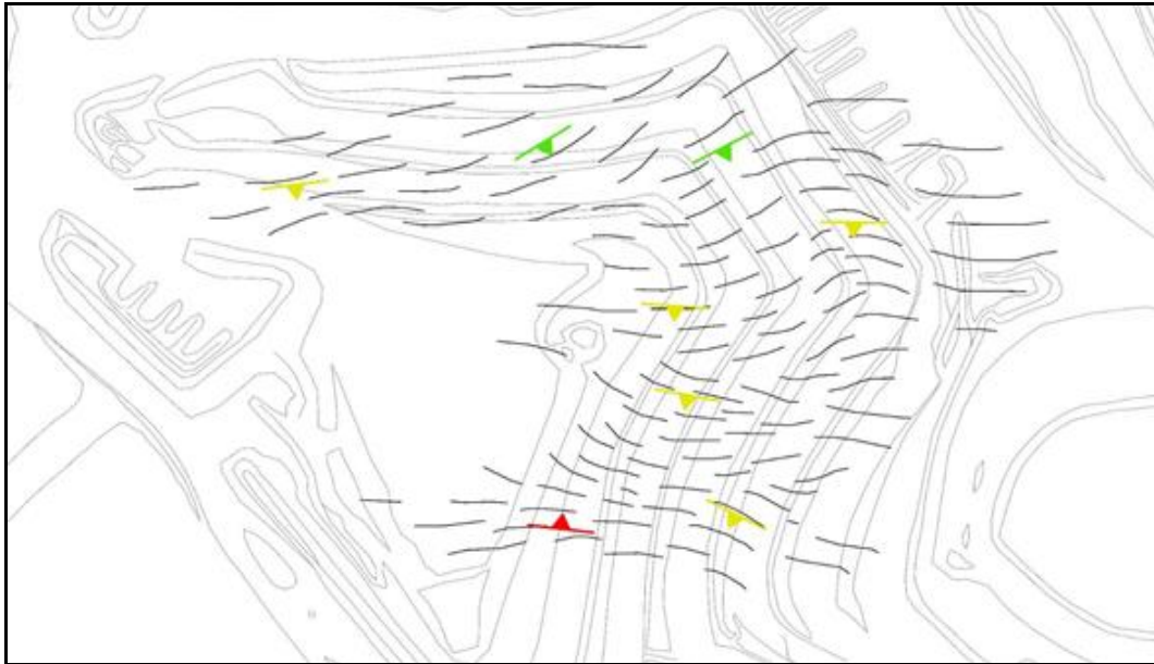
Figura 2: Construção das linhas de forma, a partir das atitudes estruturais extrapoladas obtidas com espaçamento regular e separação de intervalos de mergulho. Em preto, linhas de forma. Em cinza curvas de nível.
