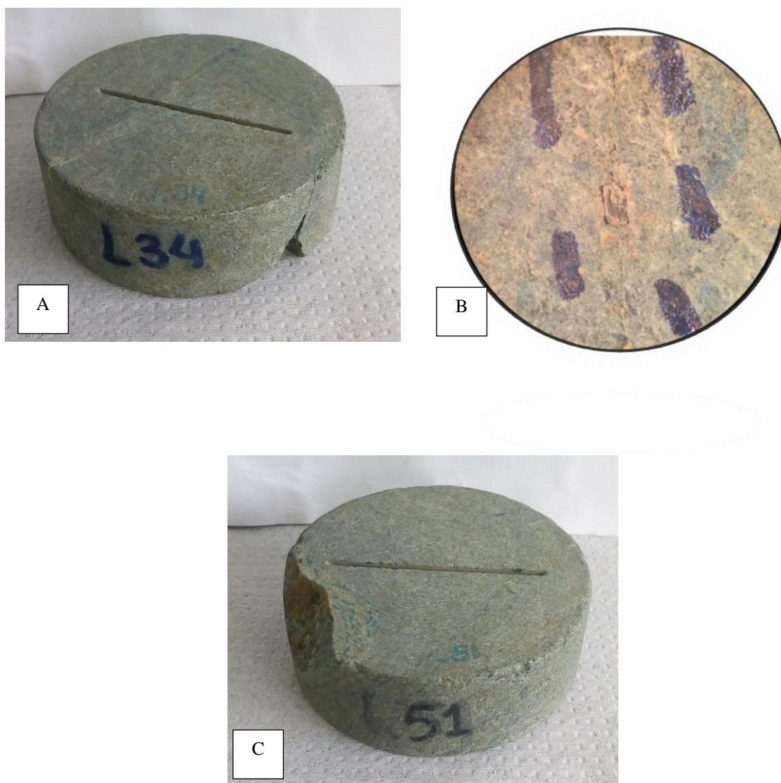
Figura 3 - Amostras representando os efeitos do processo ocorridos durante a ciclagem. A) Rachadura; B) Fissuramento; C) Lasqueamento.
