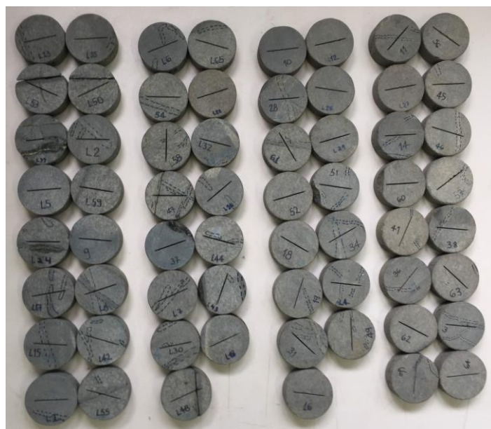
Figura 5 - Amostras após ciclagem água-estufa. Da esquerda para direita, a primeira fileira indica ciclo 20, segunda fileira ciclo 50, terceira fileira ciclo 85 e quarta fileira ciclo 105.
